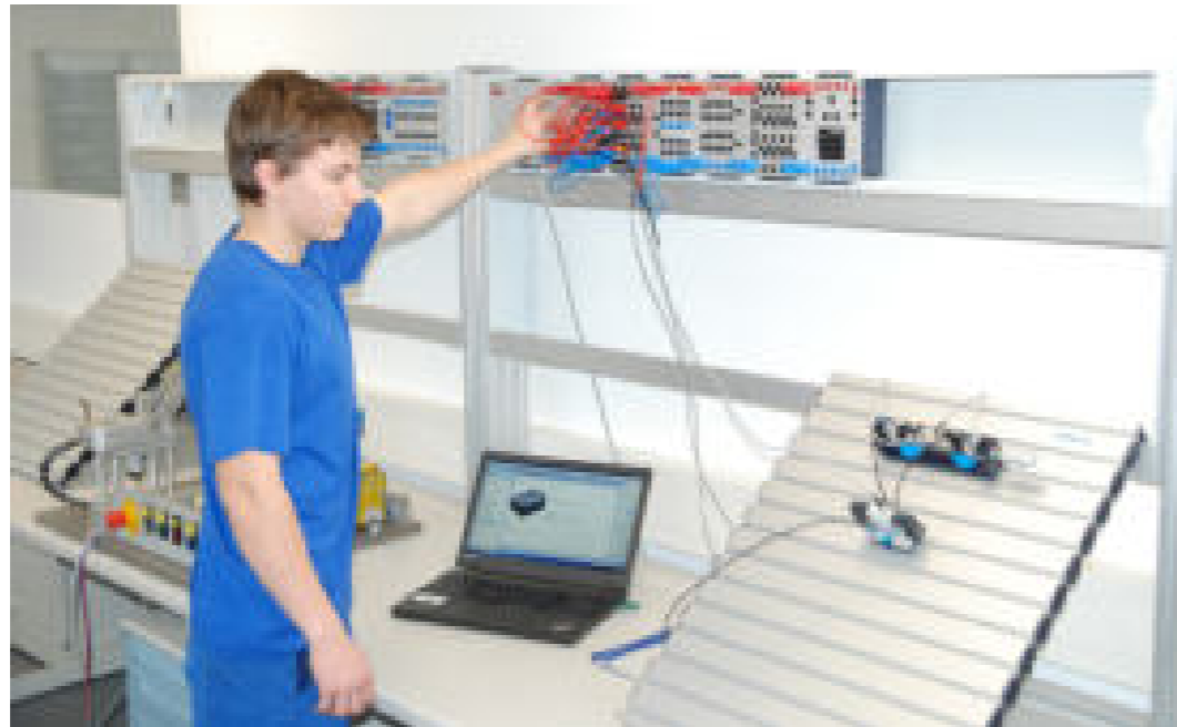
Simulation einer elektropneumatische Steuerung
