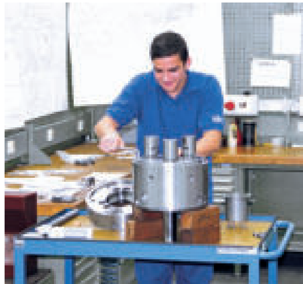
Montage eines kunden-spezifischen Sonder-Spannfutters
