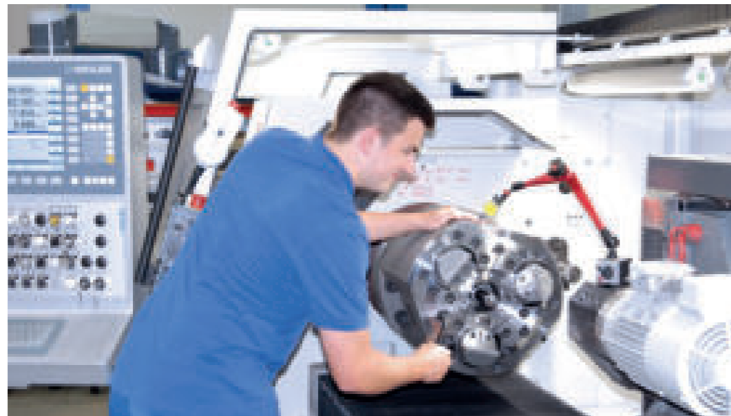
Einrichtung eines hydraulischen Spannfutters zum Testlauf
